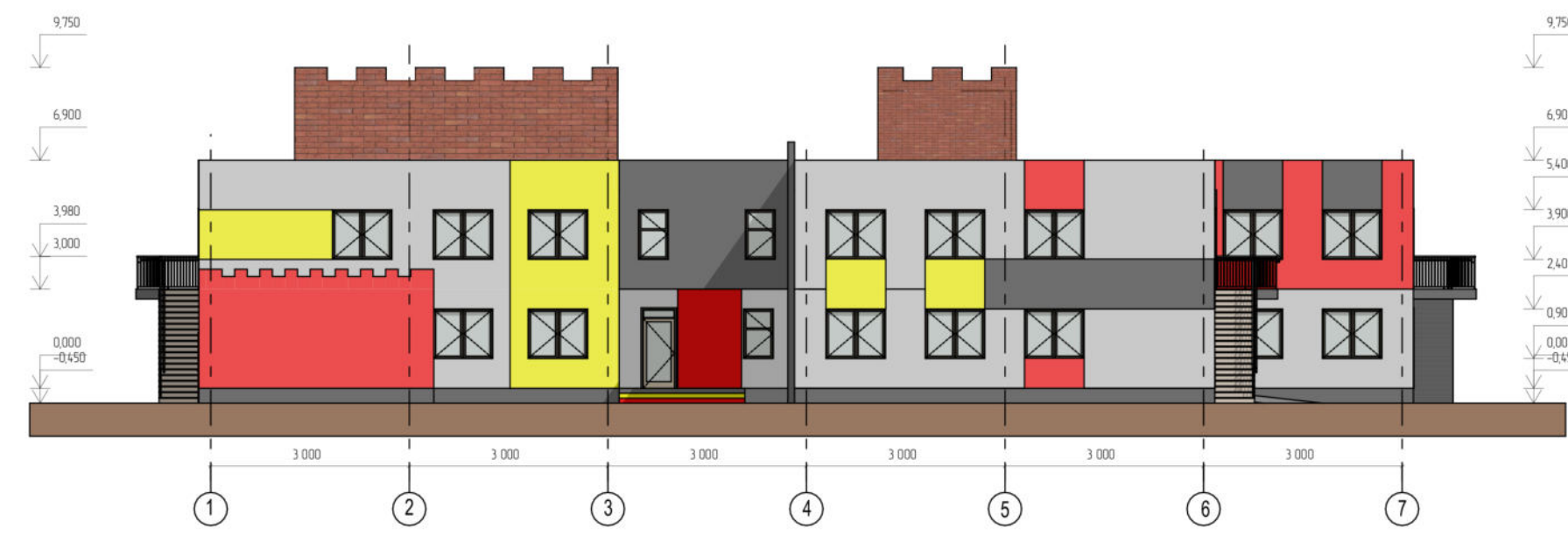
ФАСАД В ОСЯХ 1-7 М 1:200
