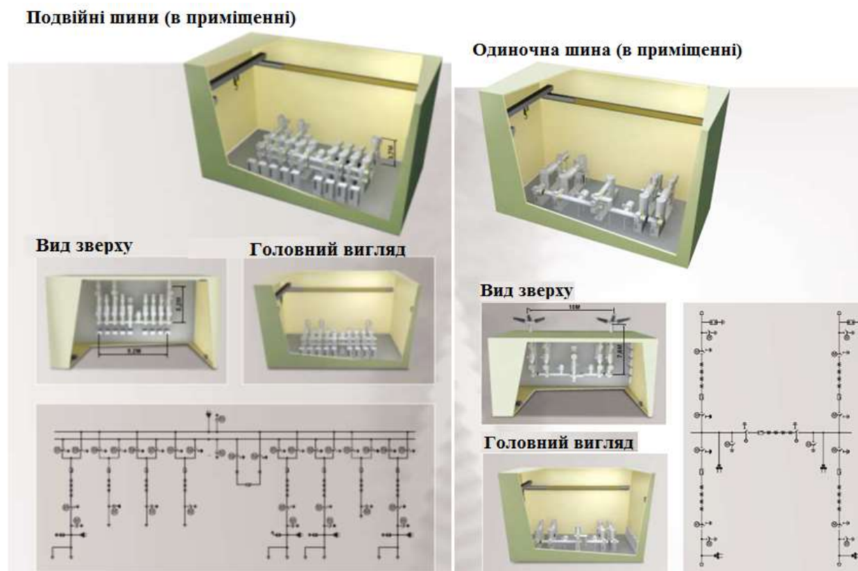
Рисунок 3.6 - КРУЕ 110 в приміщенні
