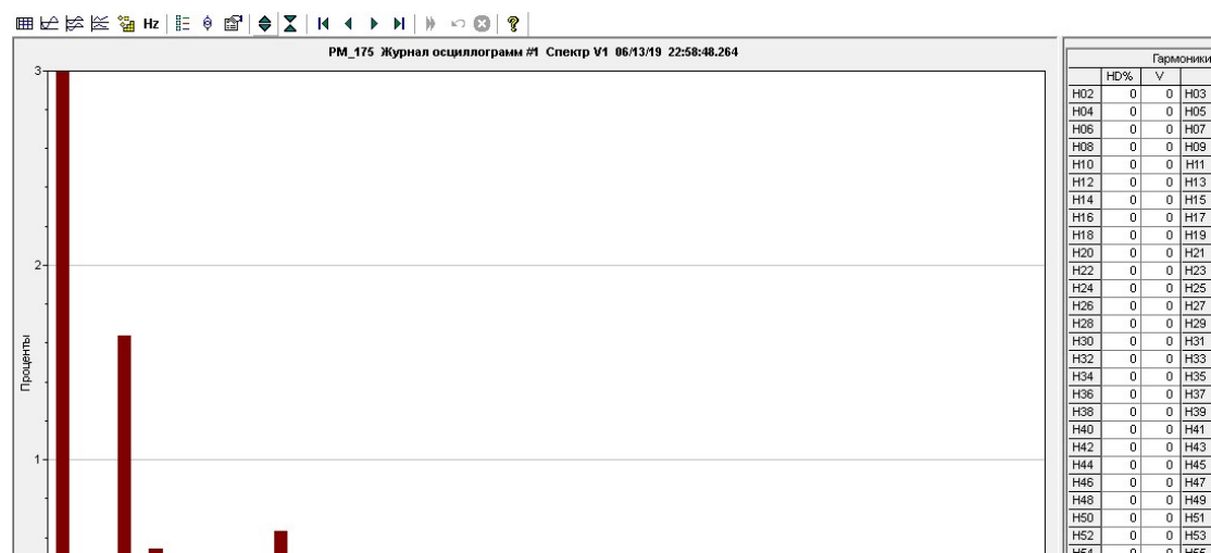
Рисунок 2.12 – Спектр гармоник о 22:58 на стороне 0,4 кВ
