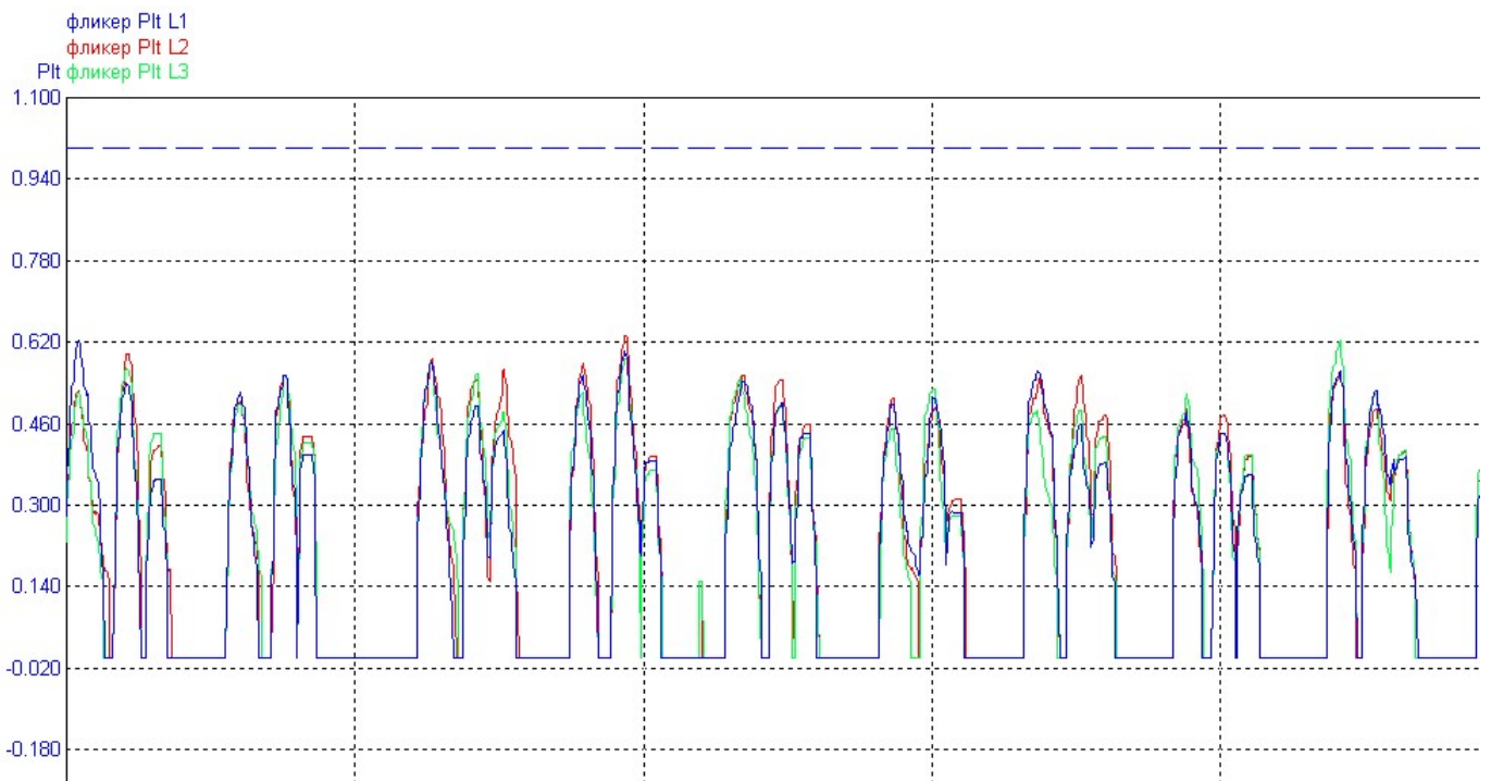
Рисунок 1.12 – Коливання флікера на протязі доби (а) та в діапазоні найбільших коливань напруг (б)
