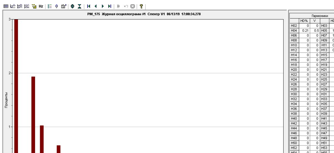
Рисунок 2.11 – Спектр гармоник о 17:00 на стороне 0,4 кВ
