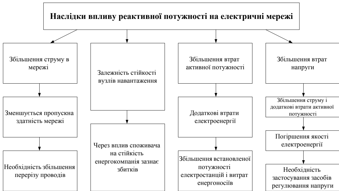
Рисунок 3.1 – Наслідки впливу реактивної потужності на електричні мережі
