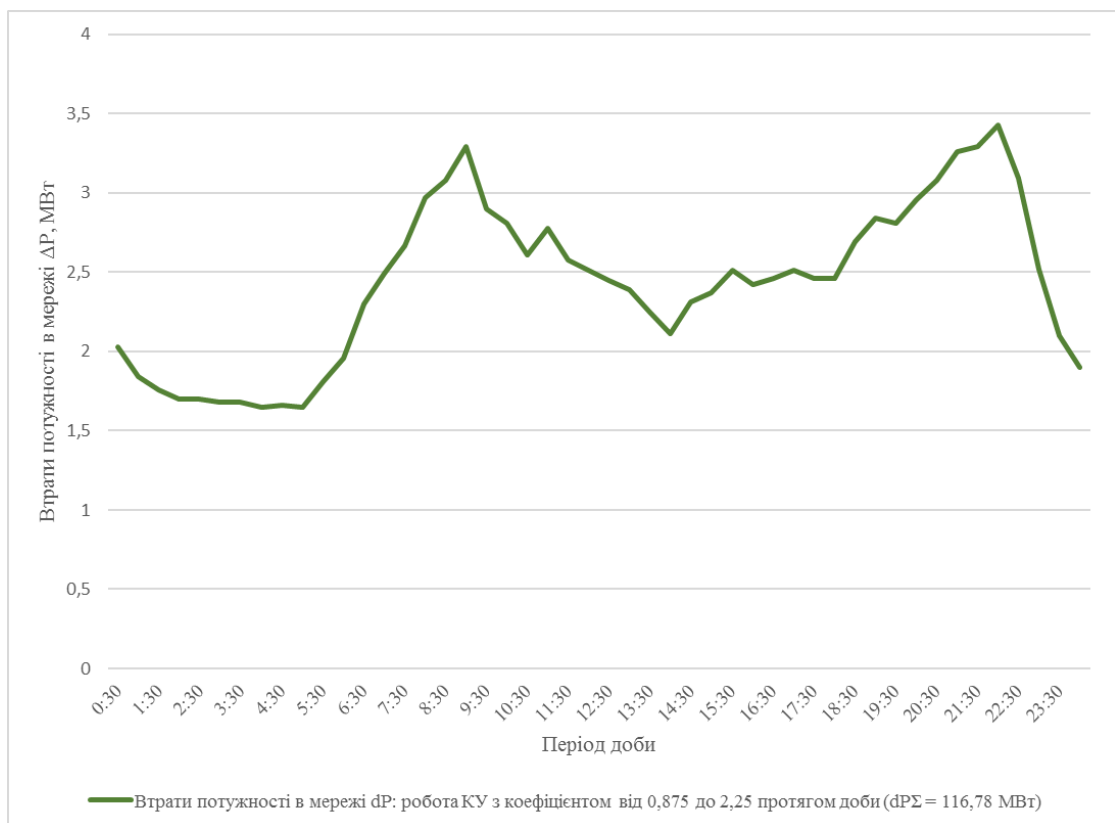
Рисунок 3.13 – Добовий графік втрат потужності в мережі
