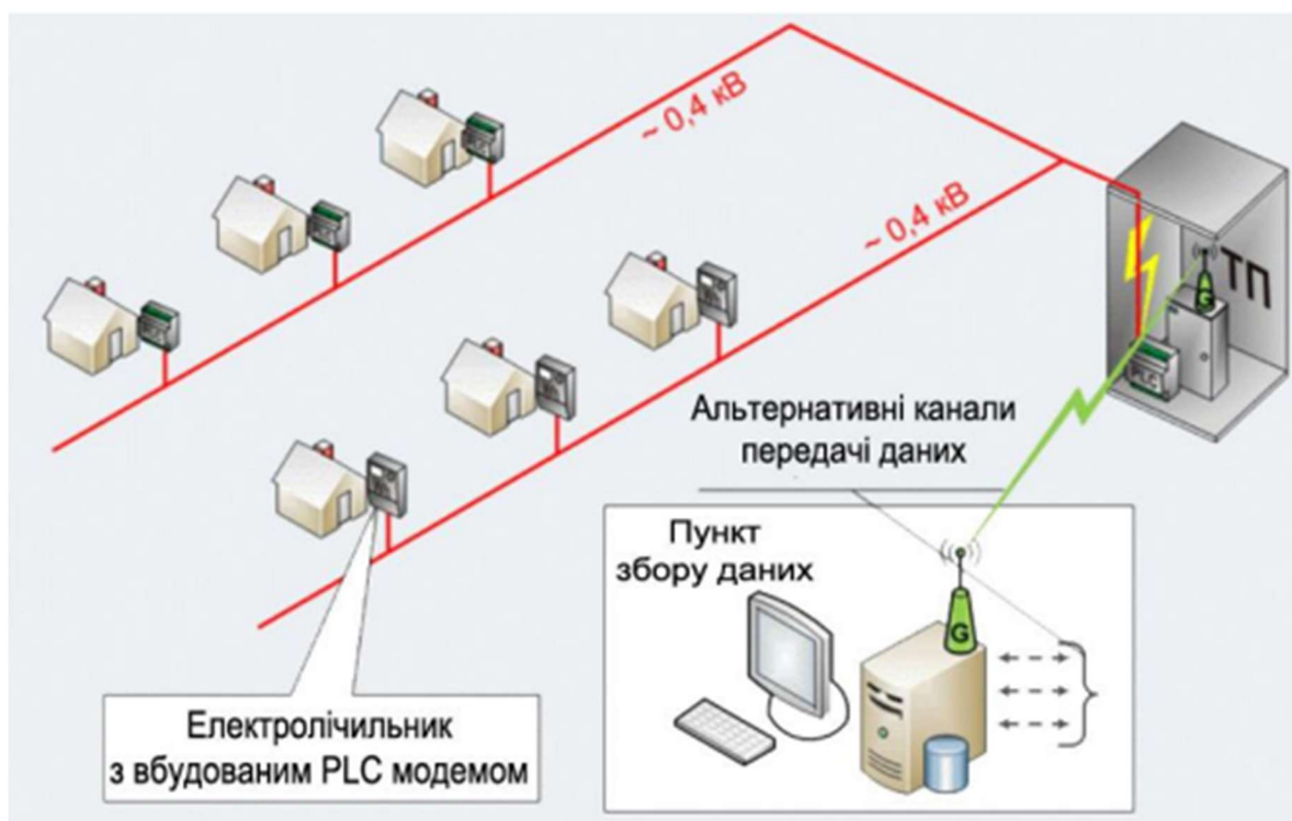
Рисунок 1.5 - Використання GSM-модему в системі автоматизованого обліку електроенергії
