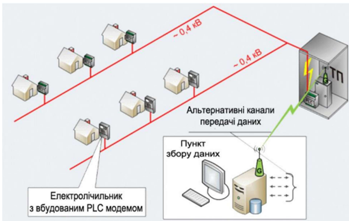
Рисунок 1.4 – АСКОЕ з передачею даних через силову мережу 0,4 кВ.
