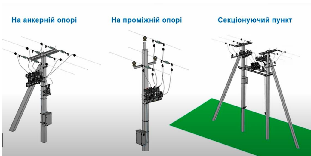
Рисунок 9.12 – Типові проектні рішення встановлення реклоузера AR12.
