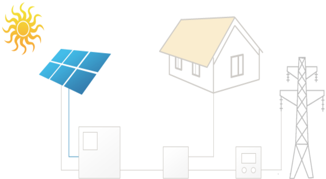
Рисунок 3.2 - Схематичне зображення домашньої мережевої сонячної електростанції
