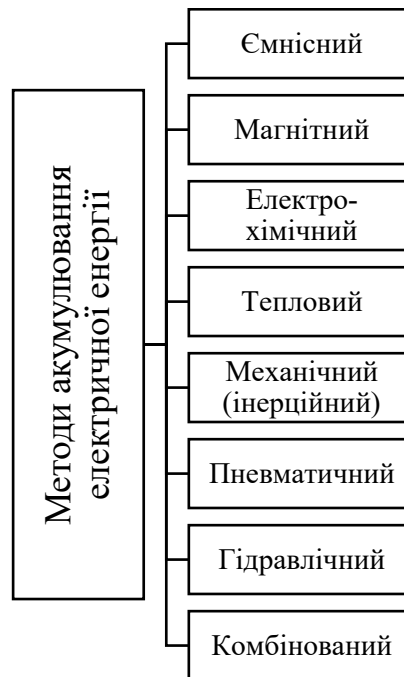
Рисунок 1.12 Методи акумулювання відновлювальної енергії
