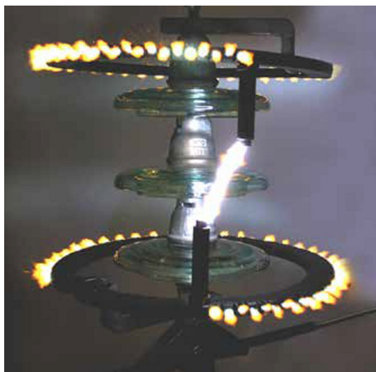
Рисунок 10.2.6 – Мультикамерна система (МКС) в роботі
