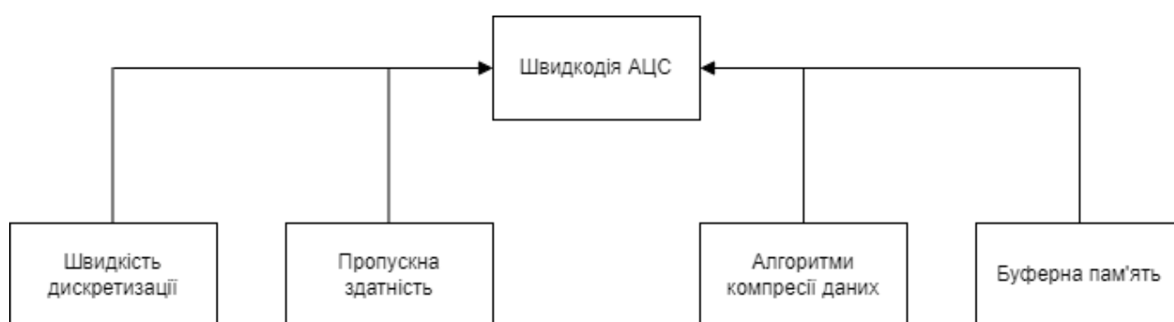
Рисунок 1.3 — Схема залежності швидкодії АЦС від різних факторів
