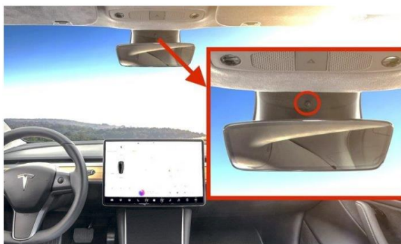
Рисунок 4.1— Місце для розташування камери в машині
