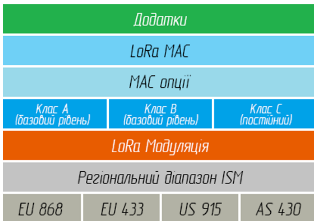
Рисунок 2.2 — Класи кінцевих пристроїв в мережах LoRa
