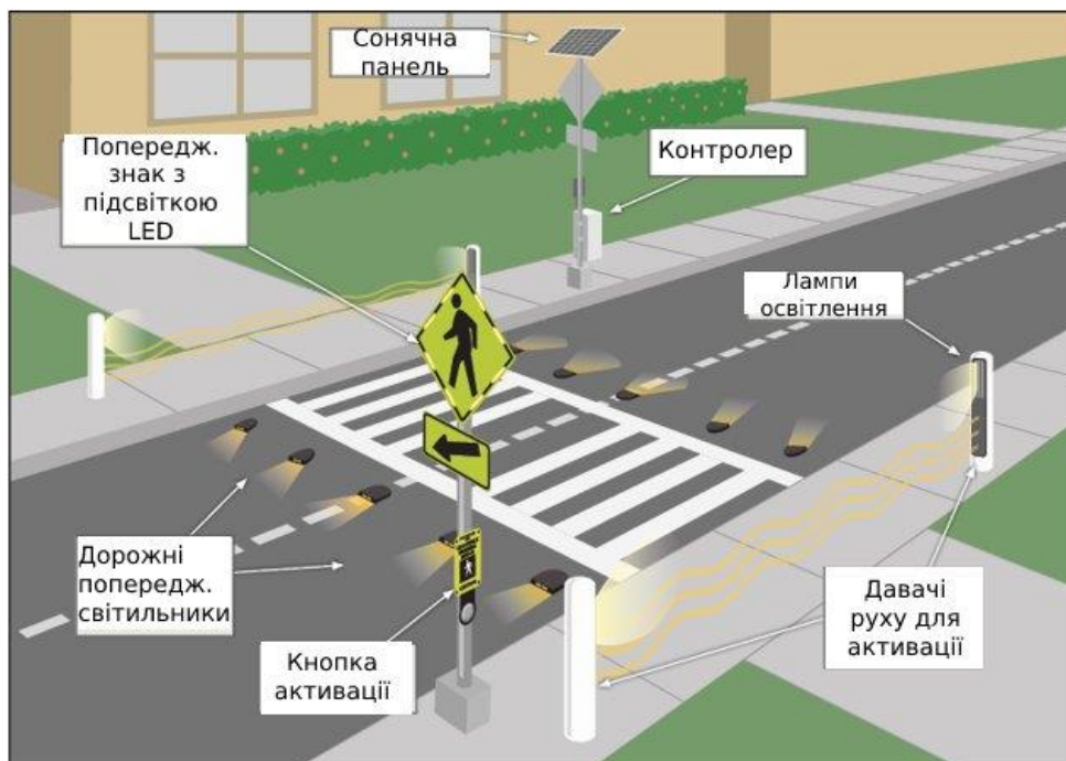
Рисунок 1.1 — Система In-Roadway Warning System
