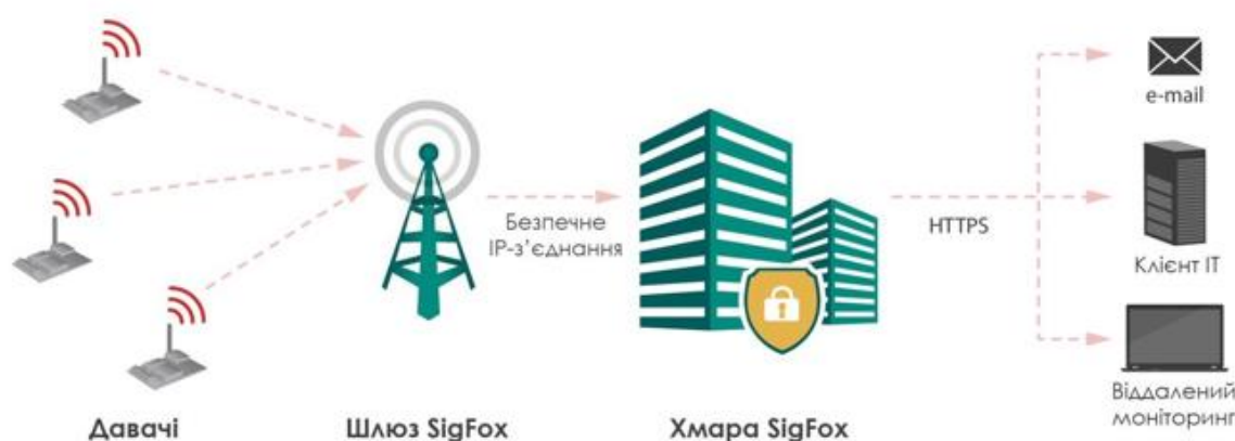
Рисунок 2.4 — Топологія мережевого стандарту SigFox
