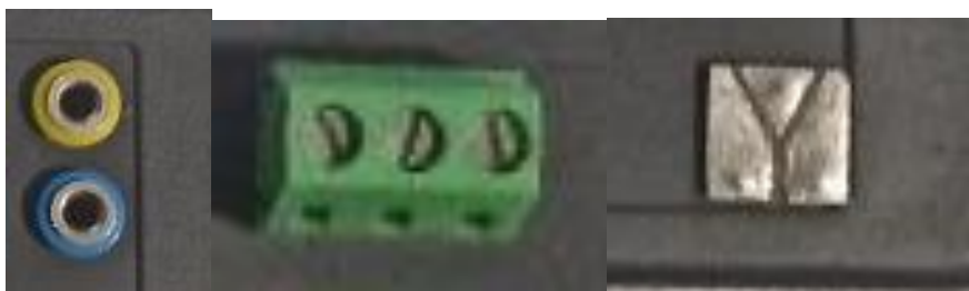
Рисунок 4.2 — Роз'єми для щупів, клемна колодка, площадка для smd елементів
