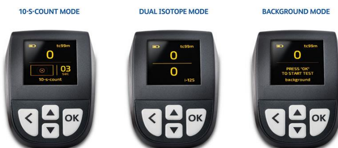
Рисунок 1.3 - Детектор радіоактивного випромінювання GAMMA-3
