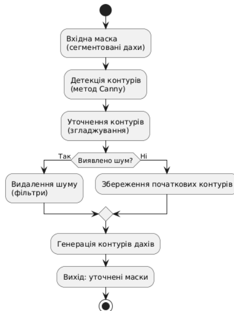
Рисунок 3.19 – Процес постобробки сегментованих дахів
