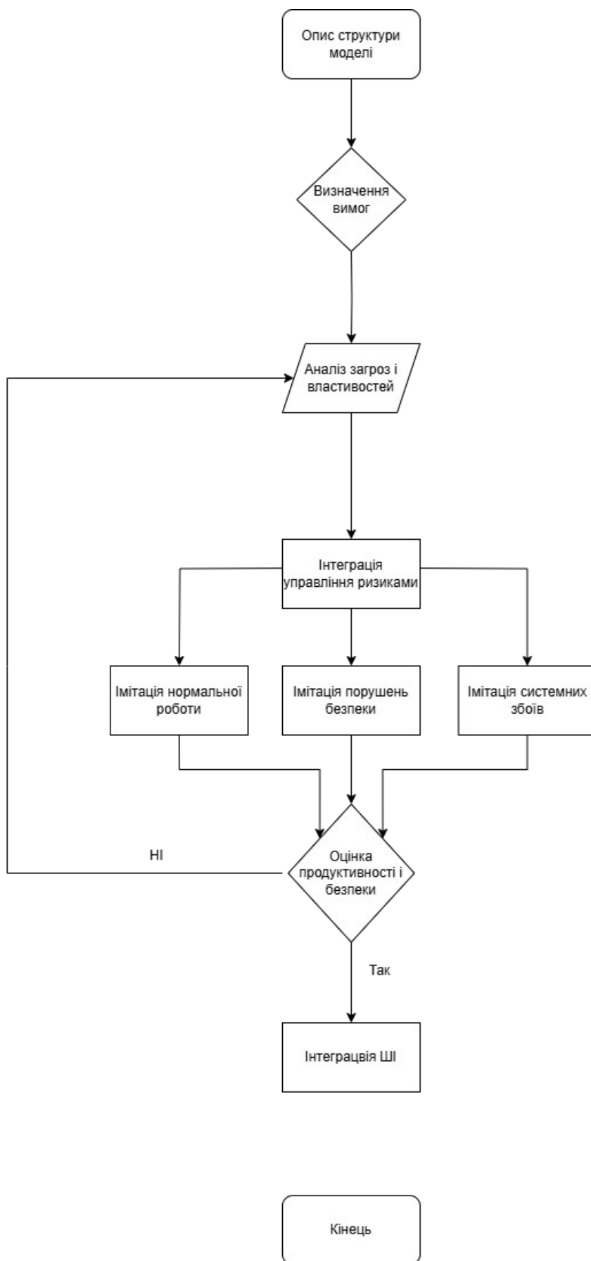
Рисунок 2.1. Алгоритм вдосконалення методу підвищення захищеності інформації від витoku каналом побічних електромагнітних випромінювань
