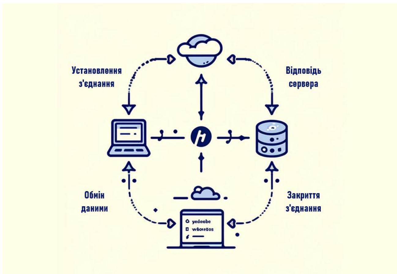
Рисунок 1.1 – Схема роботи WebSocket
