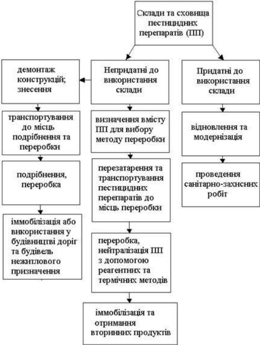
Рисунок 4.2 – Схема відновлення забруднених пестицидами земель та рекультивації територій
