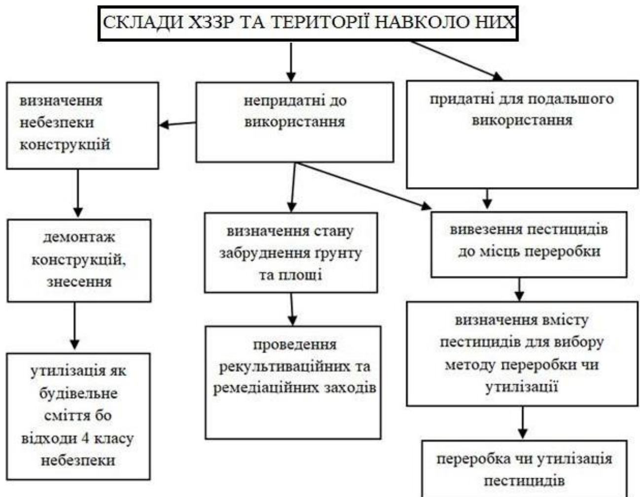
Рисунок 4.1 – Логістична схема поводження з безхозними складами непридатних пестицидів та забрудненими територіями і ґрунтами
