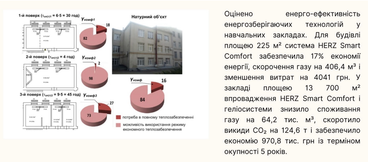
Рисунок Б.6 – Приклад результатів визначення коефіцієнту відносної потреби приміщень будівлі в комфортному теплозабезпеченні \gamma_{комф}
