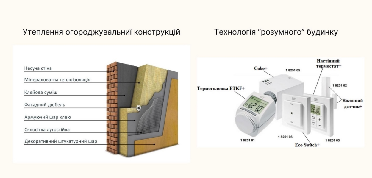
Рисунок Б.1 – Матеріали для утеплення будівлі; Складові системи HERZ Smart Comfort
