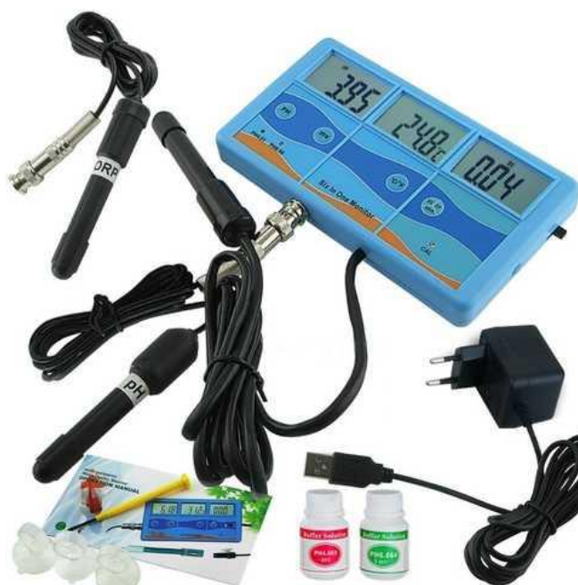
Рисунок 7 - Мультимонітор якості води WALCOM PHT-027
