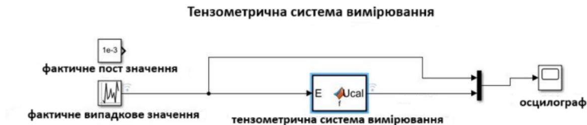
Рисунок 3.2 – Структура математичної моделі тензометричної системи вимірювання
