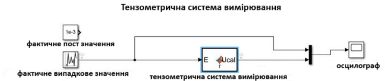
Рисунок 4 - Структура математичної моделі тензометричної системи вимірювання
