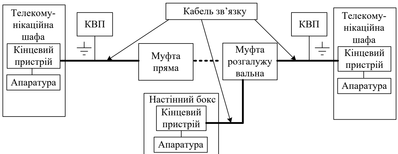
Рисунок 1.6 – Структура кабельної лінії зв'язку
