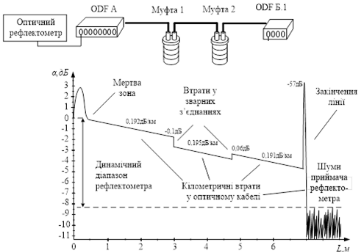
Рисунок 2.6 – Рефлектограма із відповідним подіями і неоднорідностями
