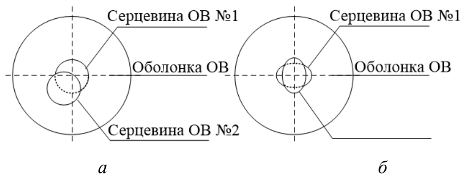
Рисунок – Відхилення геометричних параметрів оптичних волокон, що зрощуються: а – ексцентриситет серцевин; б – еліптичність серцевин
