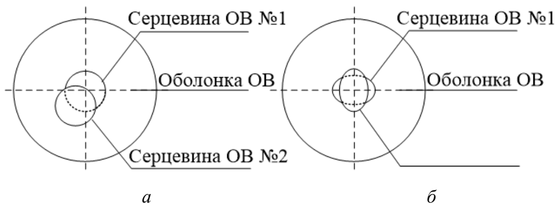
Рисунок 1.12 – Відхилення геометричних параметрів сердцевин оптичних волокон, що зрощуються:
