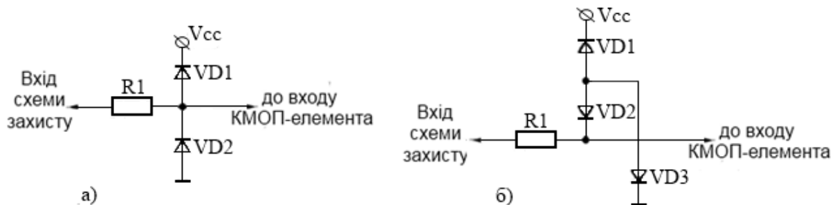
Рисунок 3.7 – Типова вхідна схема з допустимими вхідними рівнями V_{cc} = +0,3В і
