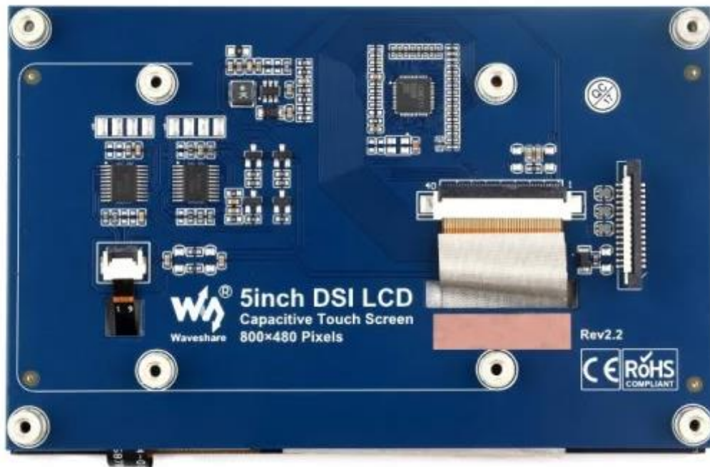
Рисунок 3.6 – Компонування дисплею Raspberry Pi 5.0inch LCD 800x480
