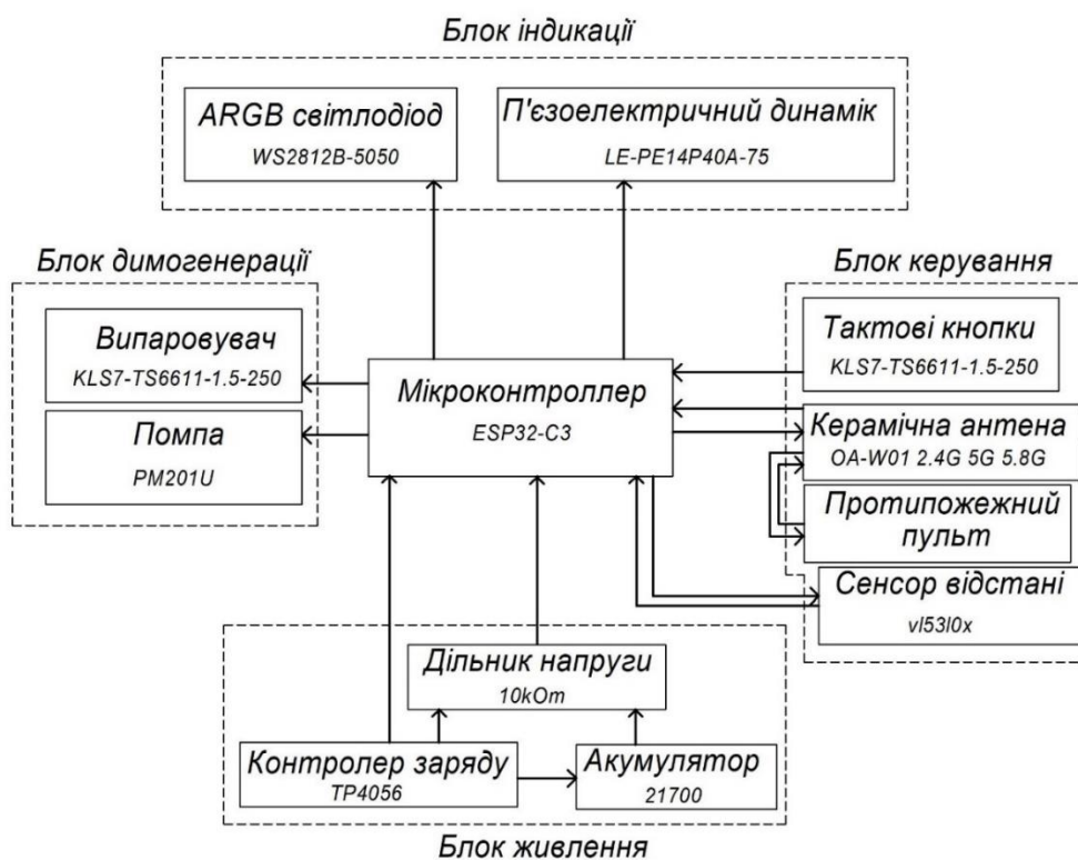
Рисунок 1 – Структурна схема радіотехнічної системи тестування димових сповіщувачів
