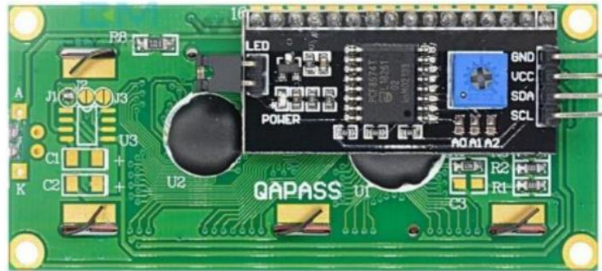
Рисунок 2.6 - Адаптер I2C для LCD 1602 2004
