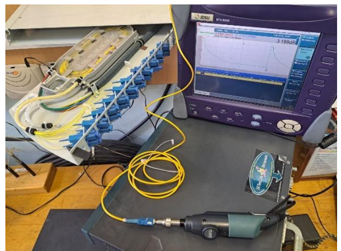
Рисунок 11 – Оцінювання якості роз'ємних з'єднань у кінцевій оптичній панелі з допомогою: а – відеомікроскопом; б - рефлектометром
