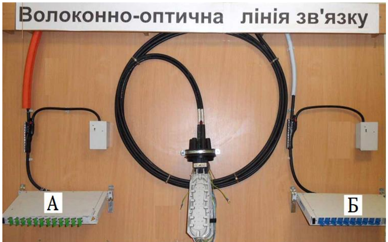
Рисунок 3.1 – Стенд волоконно-оптичної лінії зв'язку із оптичний кінцеві пристроями або панелями панелі А та Б
