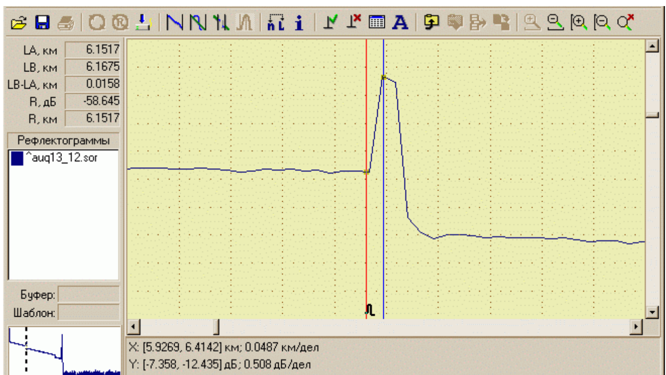
Рисунок 13 – Рефлектограма роз'ємного з'єднання отримана методом зворотного розсіювання
