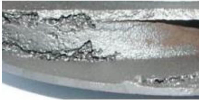
Рисунок 2.6 – Руйнування чавунного робочого колеса під впливом кавітації
