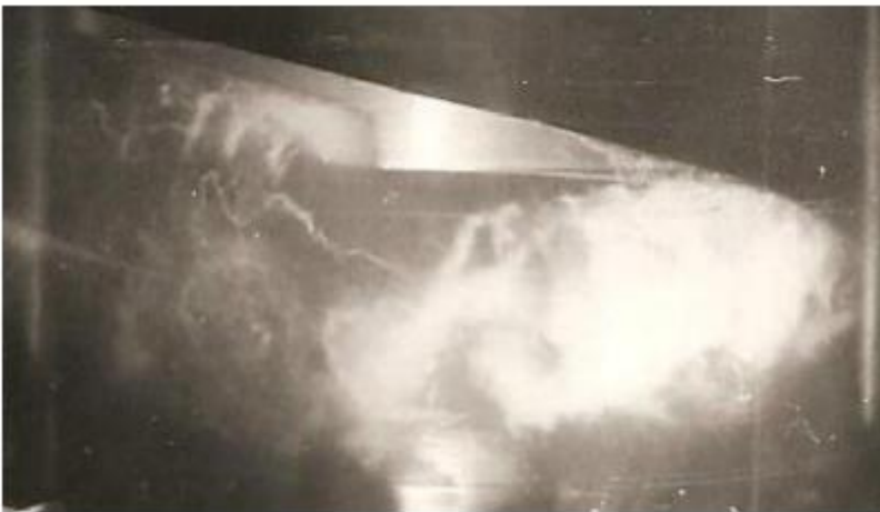
Рисунок 2.5 – Фотографія вихрової кавітації на лопатці гребного гвинта
