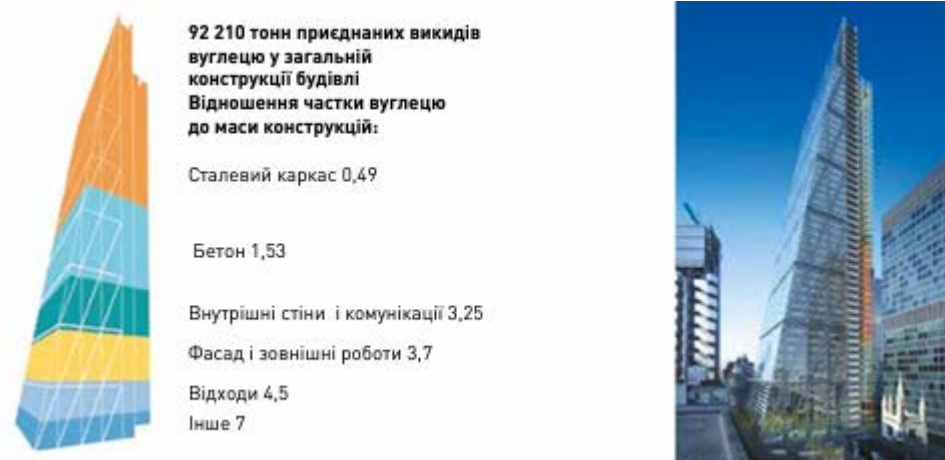
Рисунок 1.6 – Відносна структура приєднаних викидів вуглецю до маси в системі будівлі «Leadenhall» висотою 225м, Арх. R.Rogers (м.Лондон, ВБ), 2014 р
