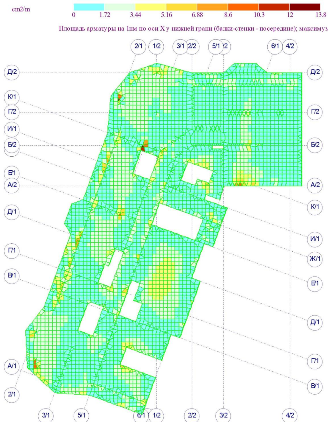
Рис. 3.20 - Армування плити перекриття на відм. +42.150
