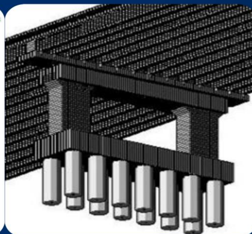
Фрагмент розрахункової моделі шляхопроводу: пластинчато-стрижнева скінчено-елементна модель під дією тимчасового впливу та її тривимірне відображення.
