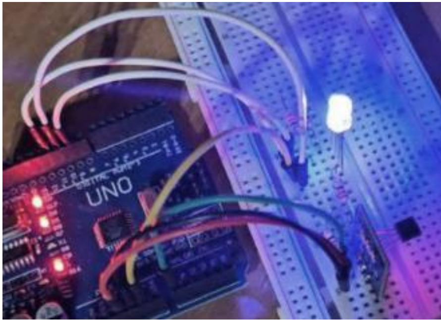
Рисунок 4.11 – Реакція датчика TMR36 на температуру нижче 20 градусів за Цельсієм
