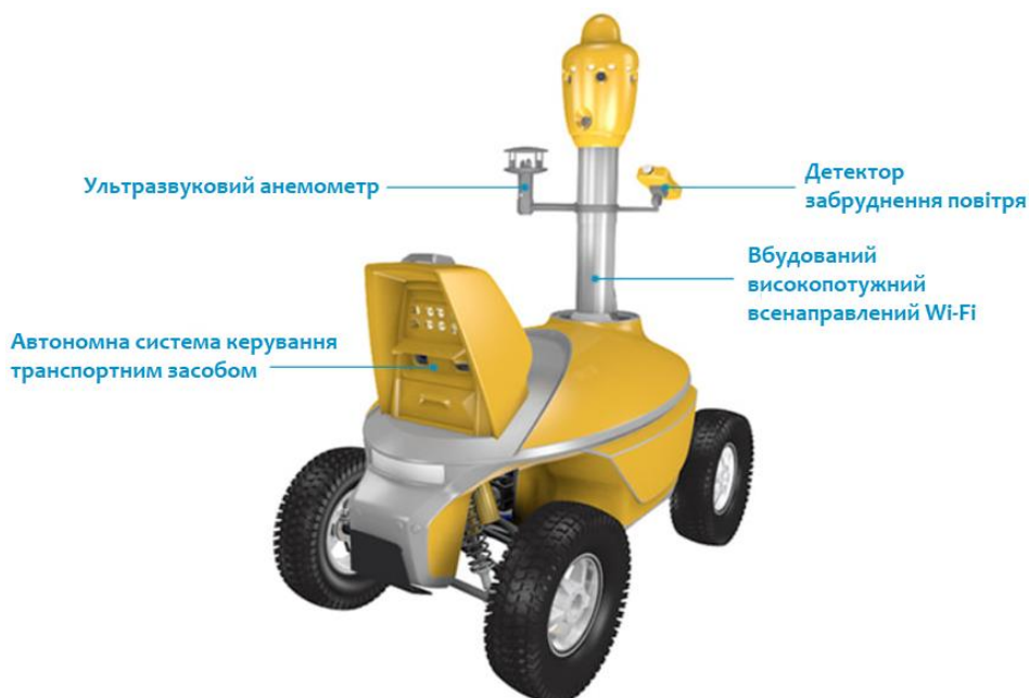
Рисунок 1.1 – Будова наземного робота для оцінки забруднення повітря
