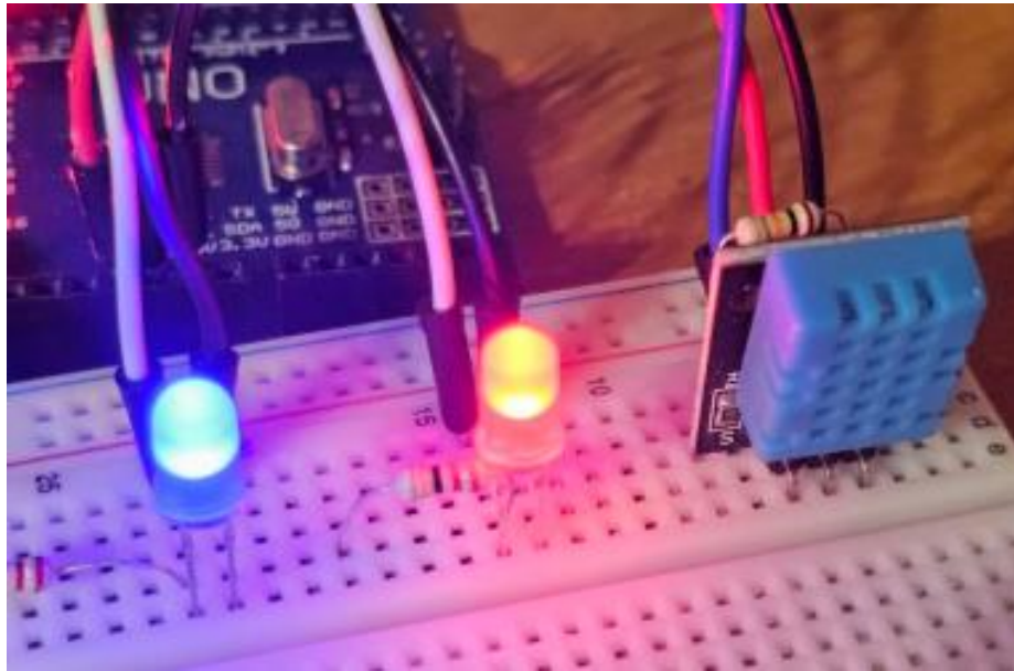
Рисунок 4.3 – Вигляд датчика DHT11 у теплих вологих умовах
