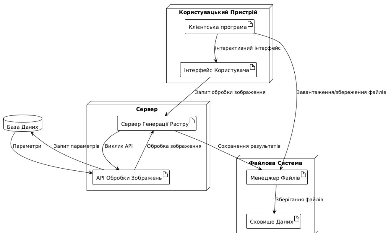
Рисунок 4.6 – UML-діаграма розгортання модуля конвертації зображень
