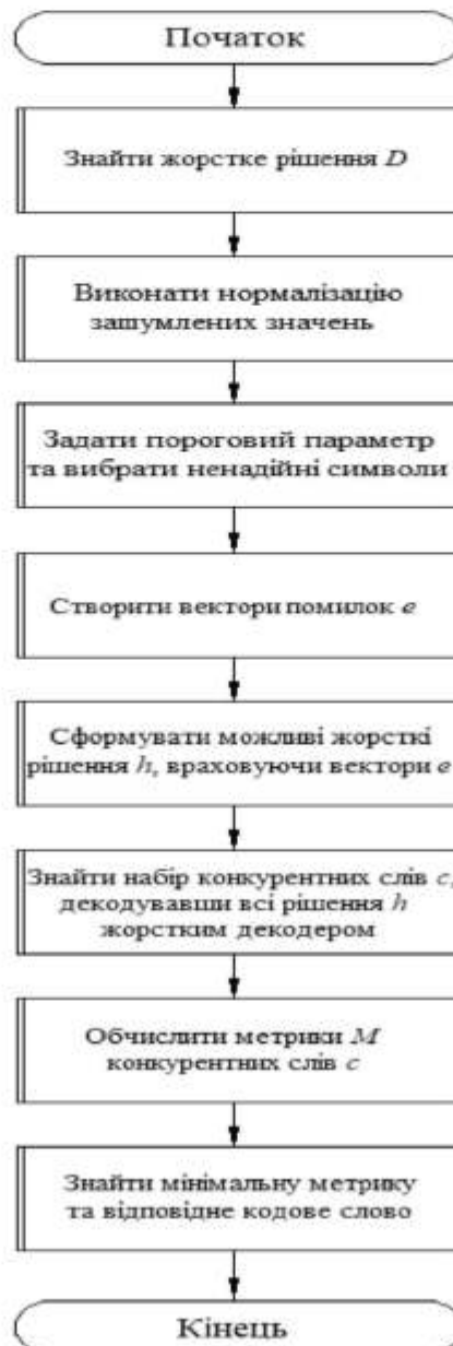
Рисунок Б.5 – Схема модифікованого методу генерації векторів помилок
