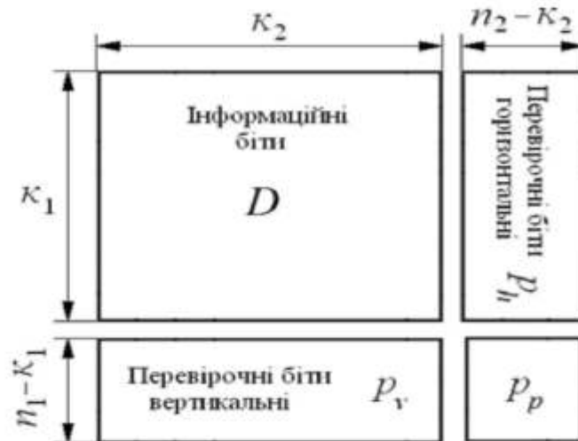
Рисунок 2.3 – Структура двовимірного блокового коду турбо-добутку:
