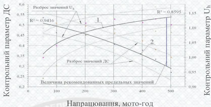
Рисунок 3.3 – Залежність зміни розробленого комплексного критерію U_h від напрацювання, а також його взаємозв'язок з контрольним параметром ДС моторної оливи G-profi MSI Plus SAE 15w40 API CI-4 / SL: 1 – U_h ; 2 – ДС
