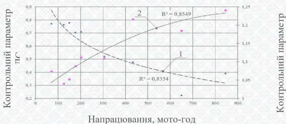
Рисунок 3.4 – Залежність зміни розробленого критерію U_h від напрацювання, а також його взаємозв'язок з контрольним параметром ДС моторної оливи М8-ДМ: 1 – ДС; 2 – U_h
