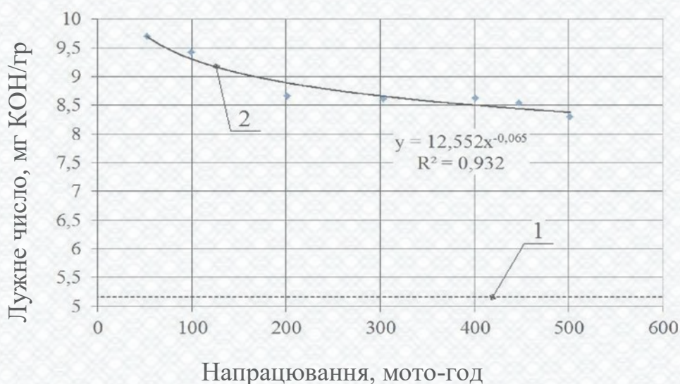
Рисунок 3.2 – Залежності зміни лужного числа моторної оливи G-profi MSI Plus SAE 15w40 API CI-4 / SL від її напрацювання
