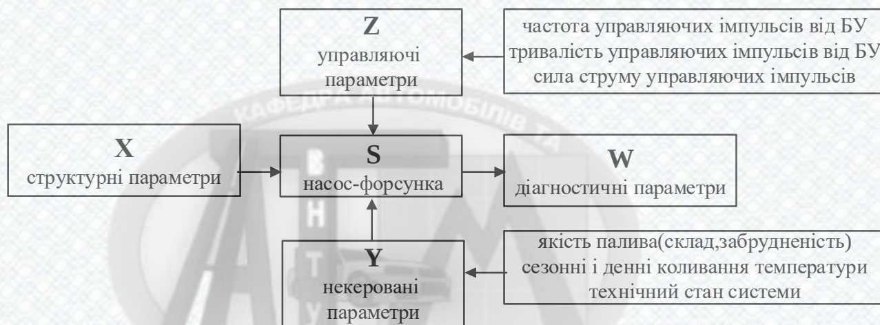
Рисунок 2.1 - Інформаційна модель функціонування насос-форсунки
