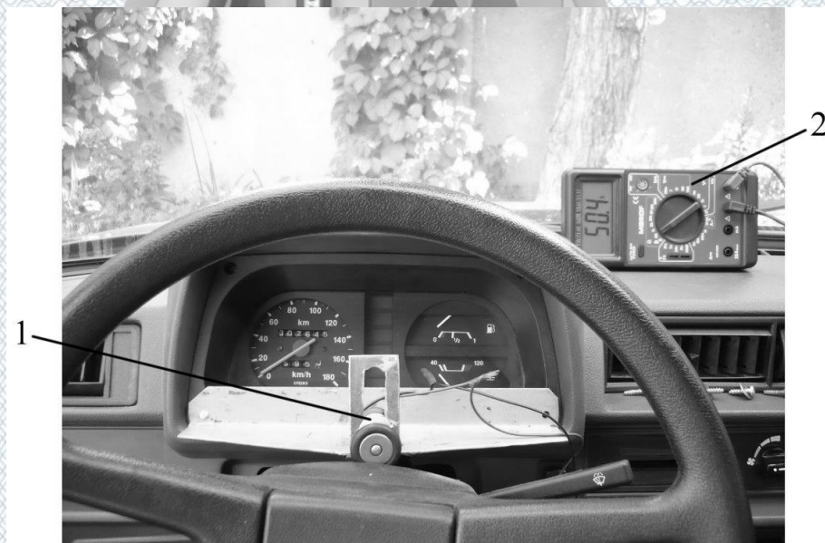
1 - дротяний потенціометр з коліщатком; 2 - цифровий мультиметр
