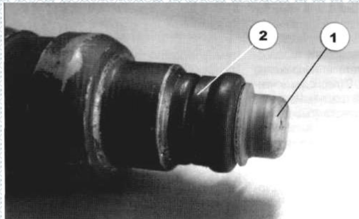
Рисунок 2.15 – Місця руйнування форсунки
