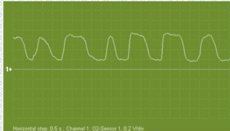
Рисунок 2.3 – Робота датчика кисню на холостому ході
