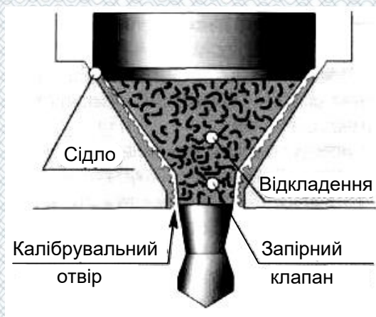
Рисунок 1.12 – Схема розпилювальної частини форсунки зі штифтовим запірним елементом
