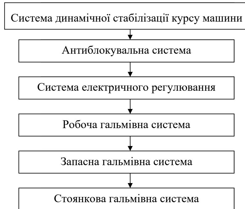
Рисунок 1.5 – Бажана ієрархічна послідовність часткових відмов керування гальмами
