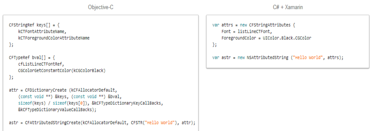
Рисунок 2.1 – Різниця між кодом Objective-C та C# на фреймворкові Xamarin
