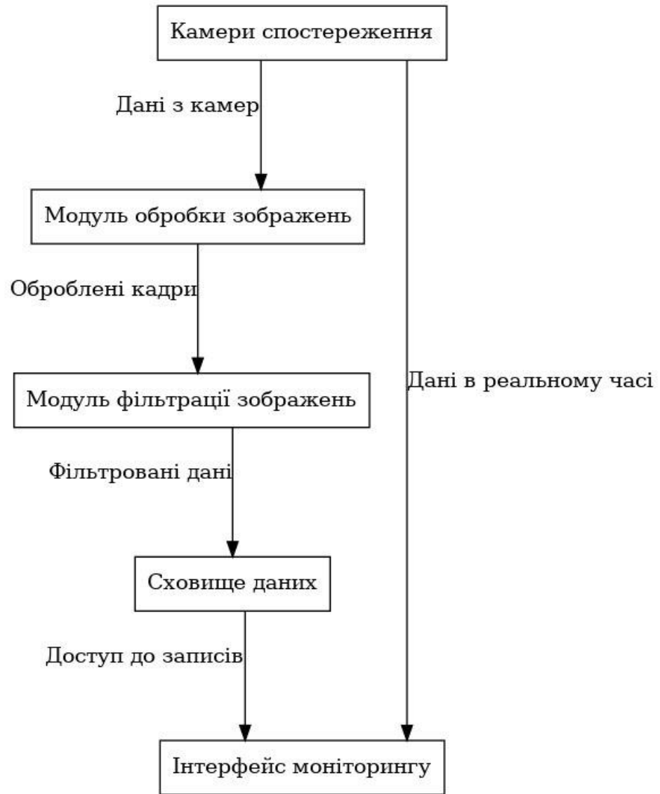
Рисунок Б.1 – Структура роботи підсистеми відеоспостереження з модулем фільтрації зображень
