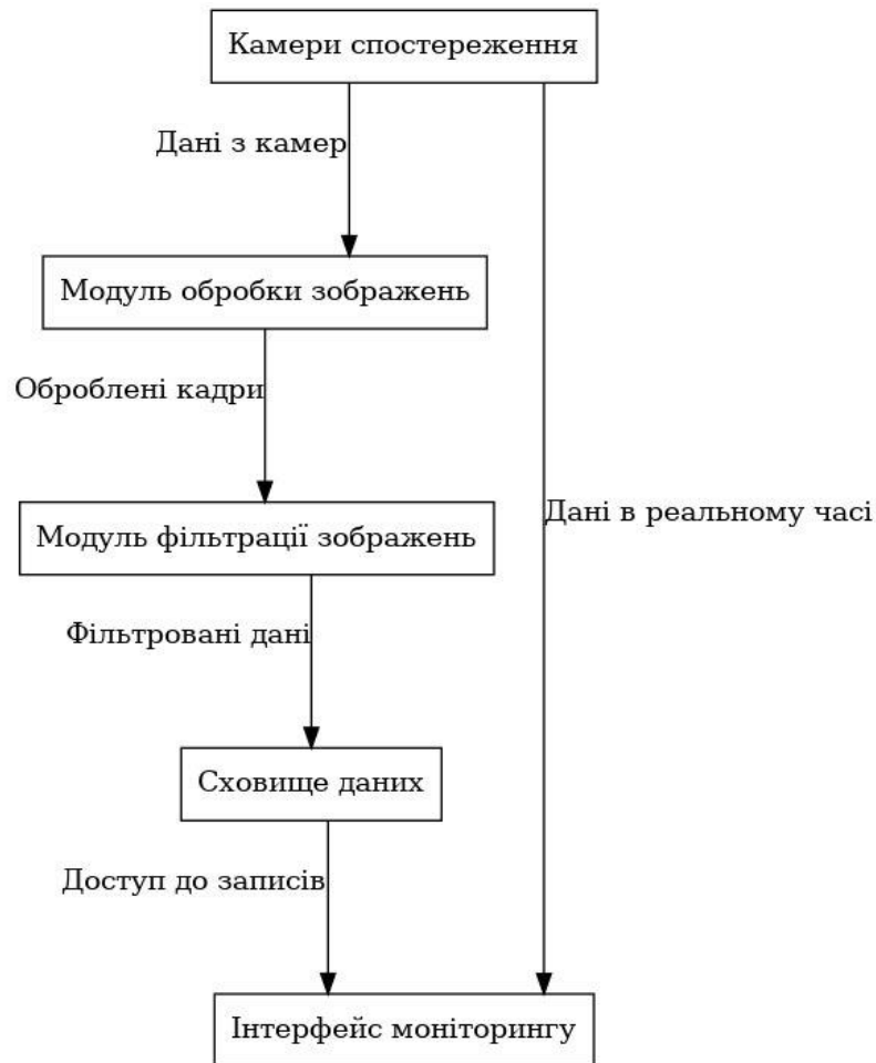
Рисунок 3.1 – Структура роботи підсистеми відеоспостереження з модулем фільтрації зображень
