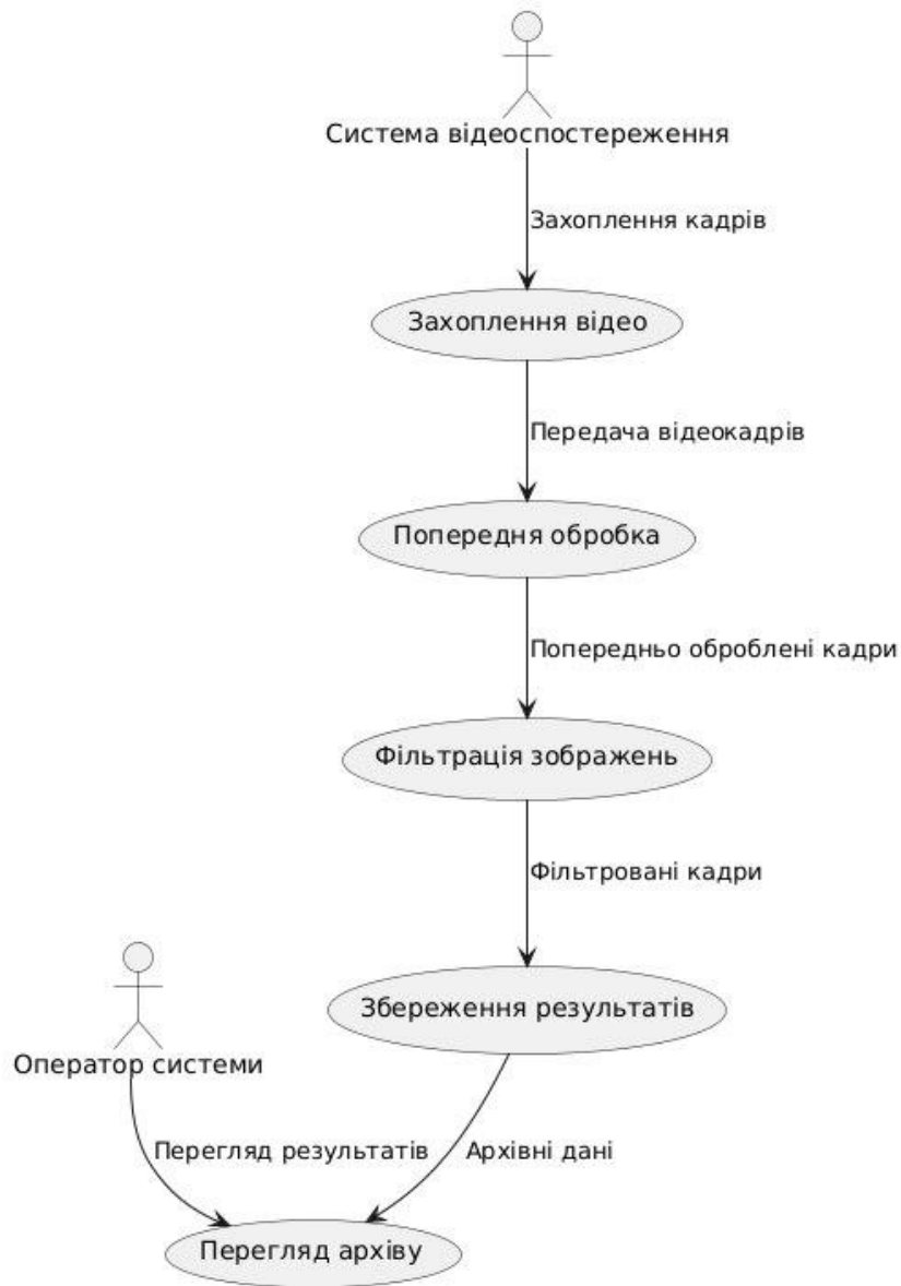
Рисунок 3.3 – Діаграма варіантів використання фільтрації цифрового зображення
