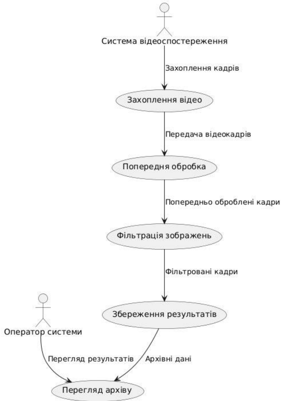
Рисунок Б.3 – Діаграма варіантів використання фільтрації цифрового зображення
