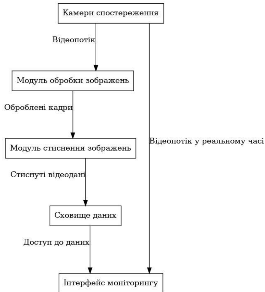
Рисунок 3.1 – Структура роботи підсистеми відеоспостереження з модулем стиснення зображень
