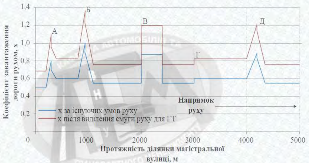
Рисунок 2.1 – Зміна коефіцієнта завантаження дороги рухом до та після виділення смуги для ГТ
