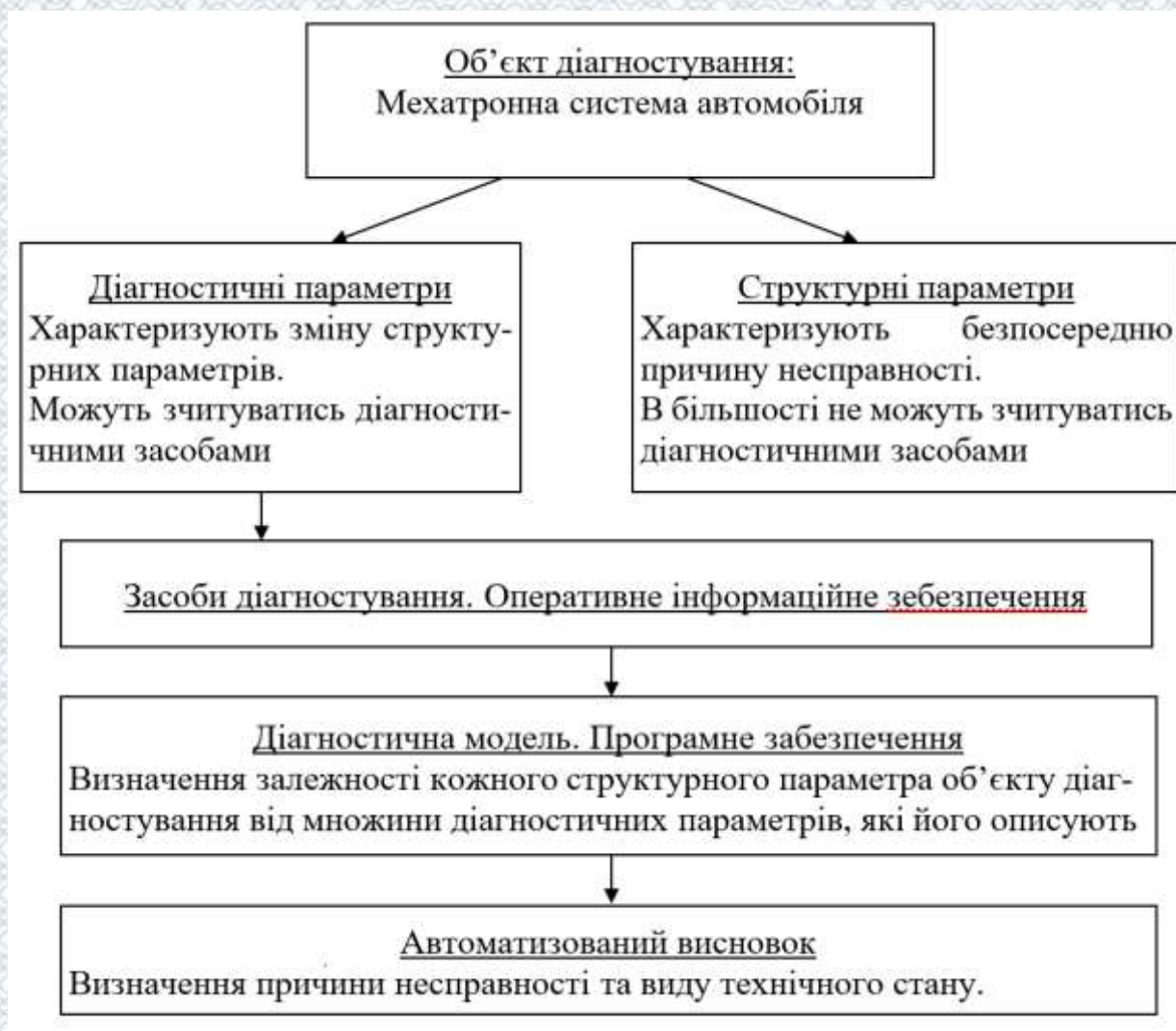
Рисунок 3.2 – Залежність між діагностичними і структурними параметрами
