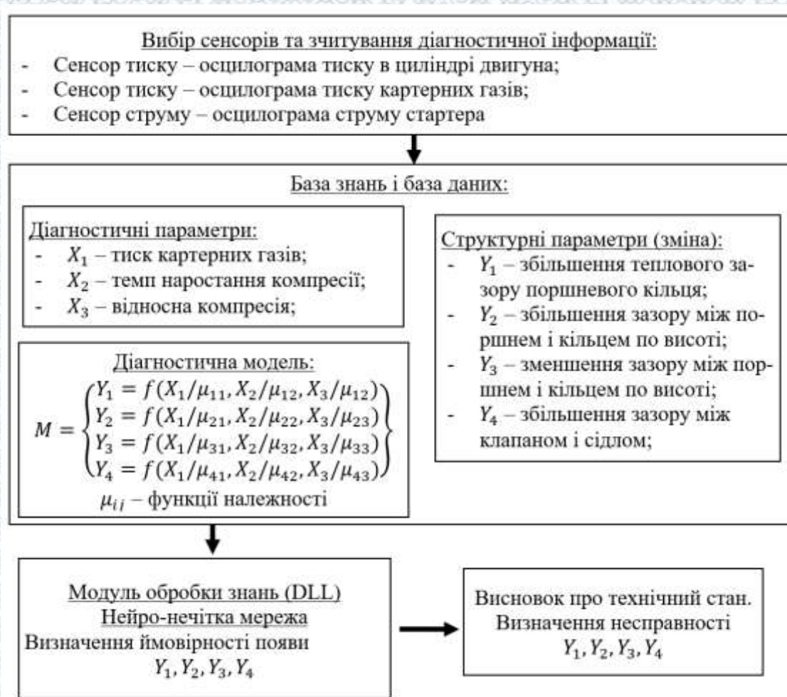
Рисунок 3.16 – Алгоритм діагностування циліндро-поршневої групи і герметичності клапанів
