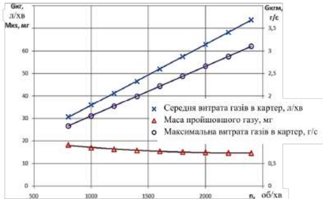
Рисунок 3.10 – Зміна середньої витрати картерних газів G_{кг} , максимальної витрати газів у картер G_{кгм} і маси газів, що надійшли в картер за цикл M_{кс} від зміни частоти обертання колінчастого валу на режимі холостого ходу при допустимому зносі ЦПГ
