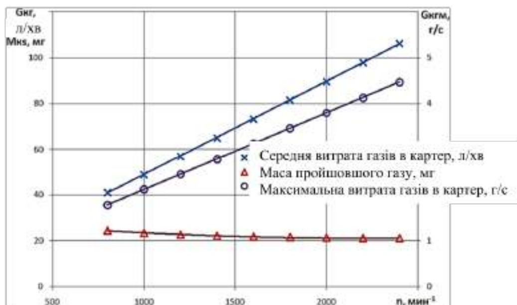
Рисунок 3.14 – Зміна середньої витрати картерних газів G_{кг} , максимальної витрати газів у картер G_{кгм} і маси газів, що надійшли в картер за цикл M_{кз} від зміни частоти обертання колінчастого валу на режимі холостого ходу при граничному зносі ЦПГ
