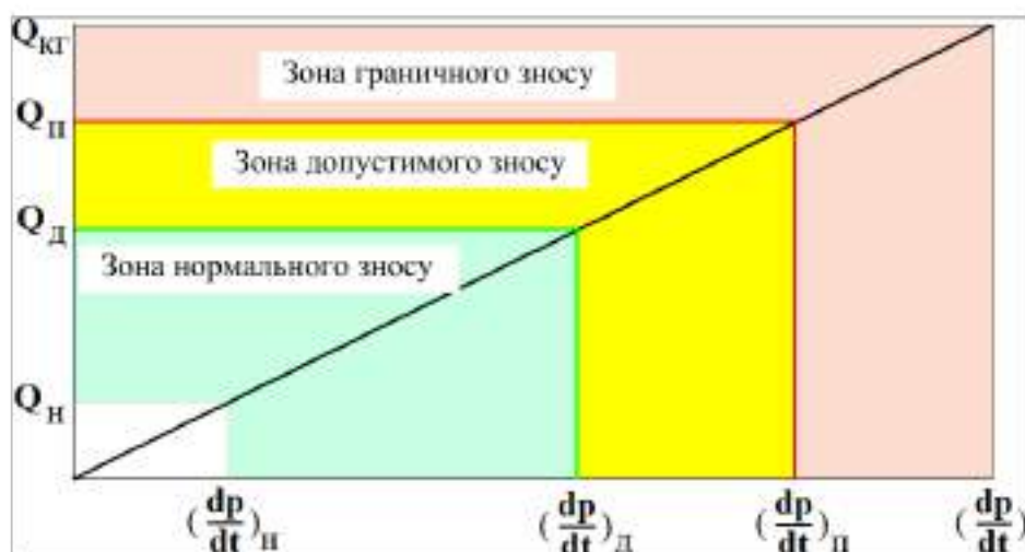
Рисунок 4.15 – Зображення зон різного технічного стану ЦПГ двигуна відносно витрат картерних газів Q_{кг} або за швидкістю наростання тиску в картері dp/dt
