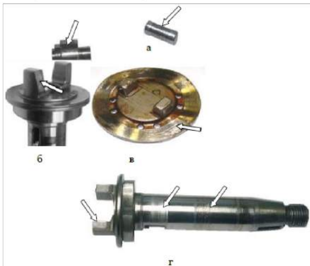
а – ролика та осі ролика; б і г – пальців приводного вала та поверхні; в – профілю кулачкової шайби
