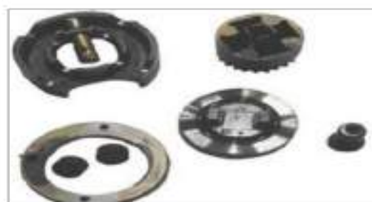
Рисунок 1.17 – Поломка елементів приводу ТНВД типу VE
