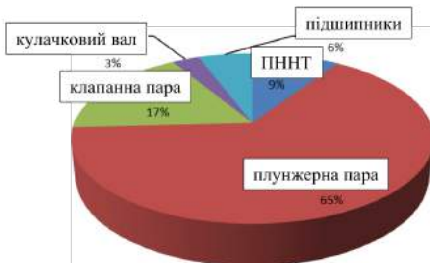
Рисунок 1.9 – Розподіл відмов деталей та вузлів паливної апаратури ДВЗ
