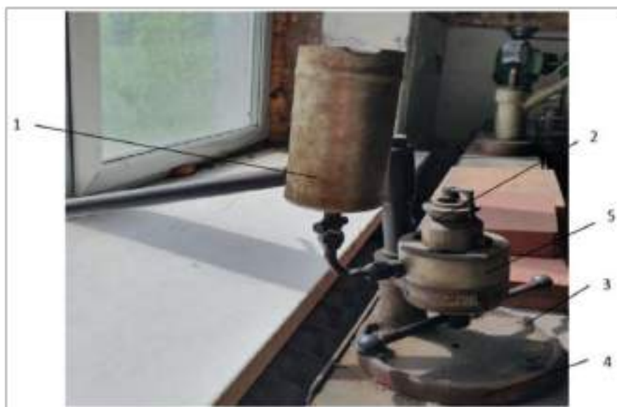
1 – паливний бак; 2 – гайка; 3 – важіль; 4 – основа; 5 – гвинт-фіксатор втулки плунжера
