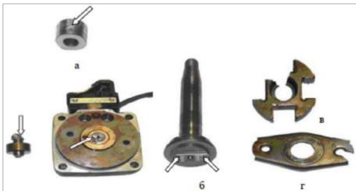
а – плунжер; б – привідна хрестоподібна шайба; в – привідний вал; г – пружинний міст
