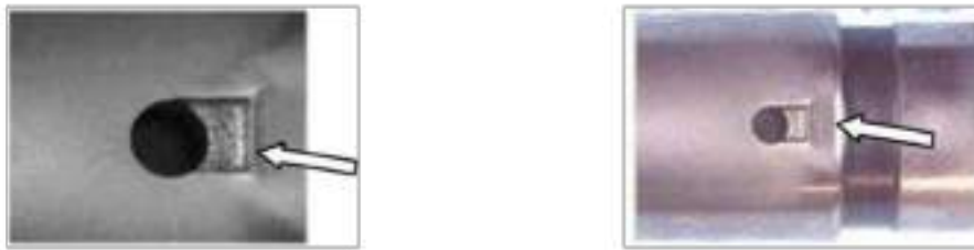
Рисунок 1.15 – Зношування плунжера внаслідок попадання абразивних частинок
