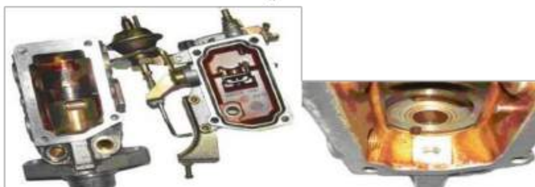
а – роликів обійма, статор ТПН, грузики регулятора в обіймі, шайба кулачкова, редукційний клапан ТПН; б, в – внутрішні порожнини корпусу та кришки регулятора ПНВТ
