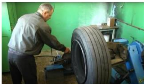
Рисунок 1.2 – Шиномонтажний стенд для ремонту коліс автобусів
