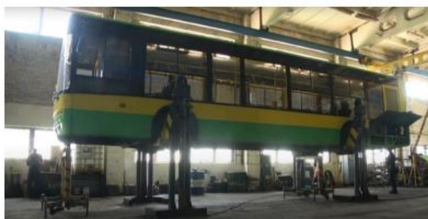
Рисунок 1.1 – Підійомник для автобусів, що виконують роботи по ТО та ПР
