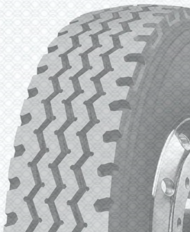
Рисунок 2.9 – Рисунок протектора універсальний (для комбінованого використання)
