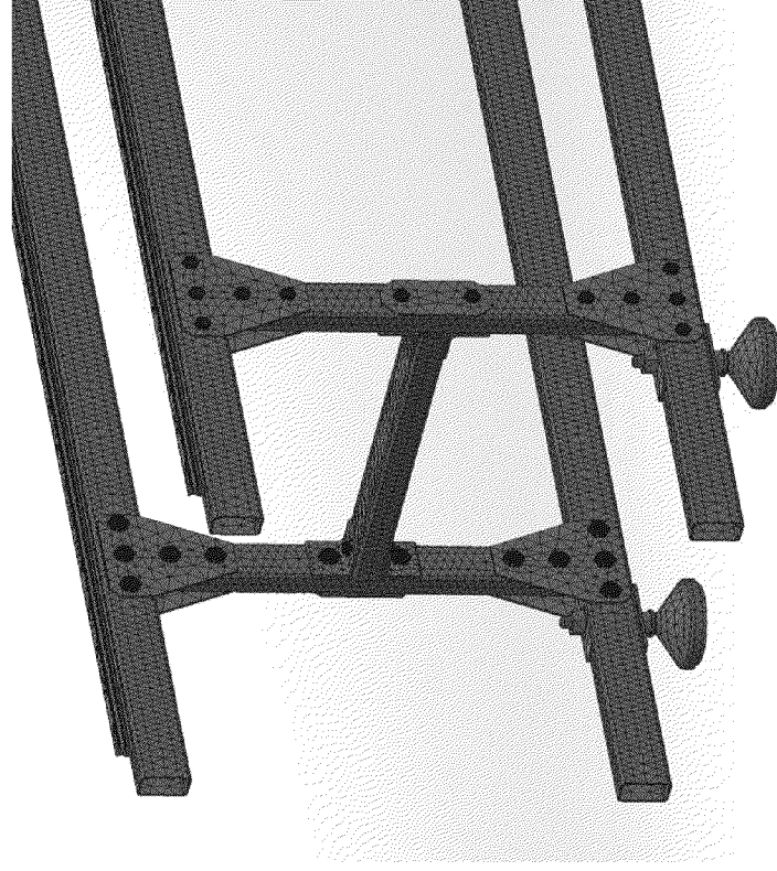
Рисунок 1 – Конструктивне рішення рами приводу
